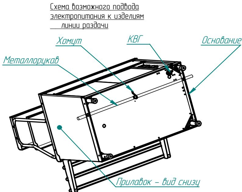
В основаниях изделий линии раздачи введено сквозное отверстие диаметром 29,5 мм и поддерживающие хомуты для возможности проведения металлического гофра с питательными кабелями сквозь все изделия линии раздачи.
